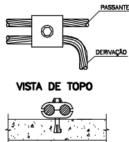
CONECTOR DERIVAÇÃO SEM ESCALA
